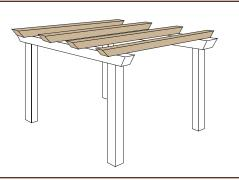
**Travesaños o largueros**De soporte de cubierta mecanizados para encaje de 160x160m. de sección y
